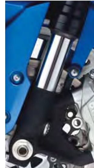
> Tauchrohre und Simmerringe prüfen
