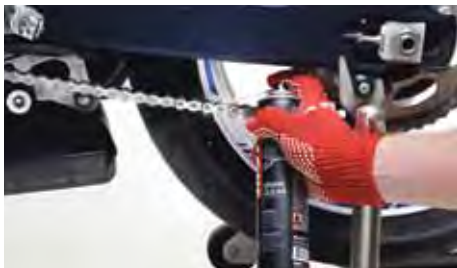
> MOTUL Kettenspray immer auf die Innenseite sprühen
