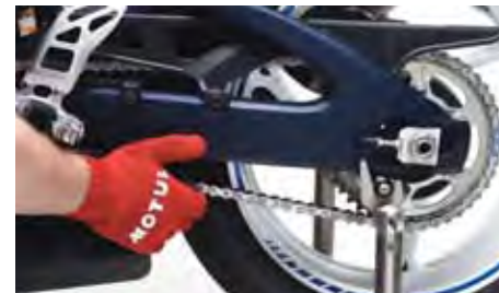
> Sekundär-Kette auf „Durchhang“ prüfen
