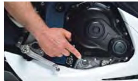
> Ölstand am Schauglas überprüfen
